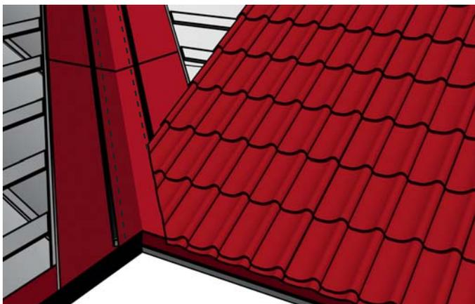
Смонтируйте обрезанные листы кровельного покрытия поверх ендовы, при этом убедитесь, что угол ендовы расположен четко вдоль направляющей линии.
