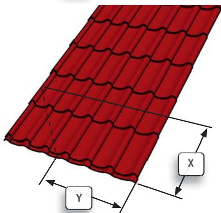
Нанесите линию среза на листе кровельного покрытия.
