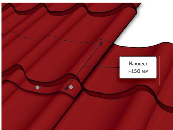
Листы металлочерепицы при наращивании соединяют вдоль ската с нахлестом минимум 150 мм и крепят к обрешетке в низ каждой продольной волны под поперечную волну профиля.
